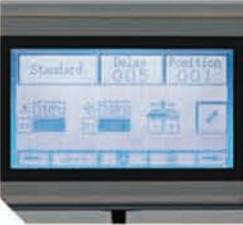
操作者可通过触摸屏选择工位、设定生产速度及塑封温度。同时，在触摸屏上还有可重置的计数器，并显示当前生产速度、塑封温度、故障位置，以及其他详细设备运行状态信息。塑封温度可根据生产速度进行预设，但操作者也可以根据塑封材料的厚度对温度进行适当调节。
